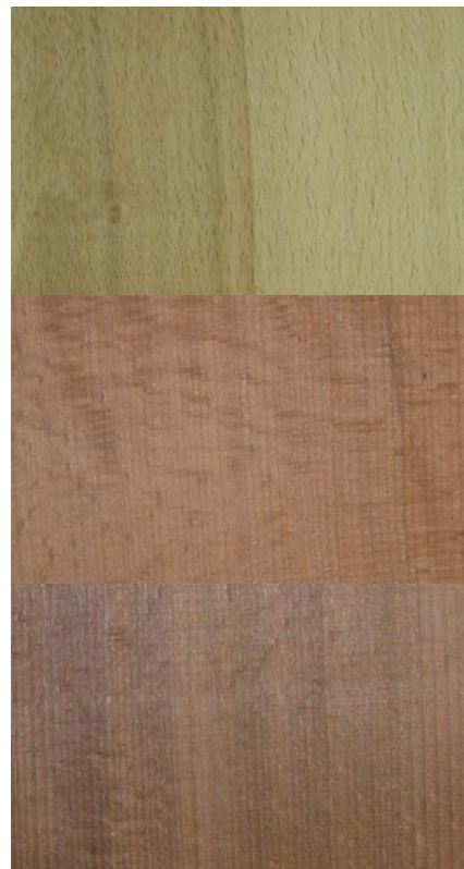
Mit zunehmender Behandlungsstärke (oben: Stufe 0; Mitte: II, unten: III) wurde das Holz der Rotbuche deutlich dunkler.
